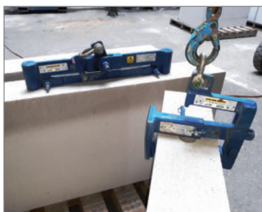
Links: elementenklems Rechts: gebruik passtukkenklem
