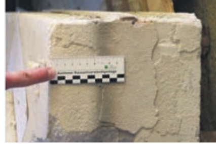
Kleurverandering door chemische omzetting van CSH-fasen na vuurbelasting
