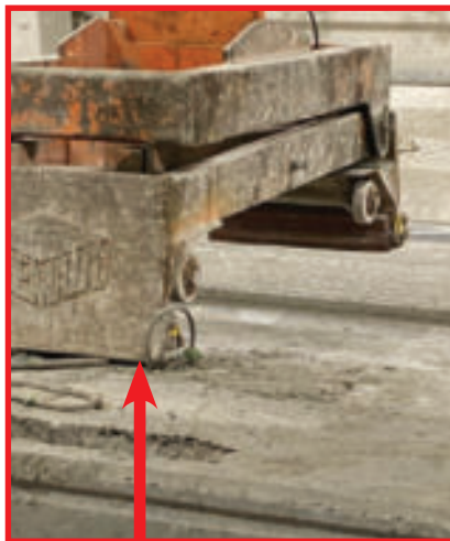
Maar toen de klemmen naar boven bewogen, verbonden zij zich met de hijsog. Door deze trekkracht of kracht op de lip verschoof de plaat en gleeed van de stapel platen af (zie volgende foto) - de bediener ging ervan uit dat de klemmen helemaal vrij waren.
