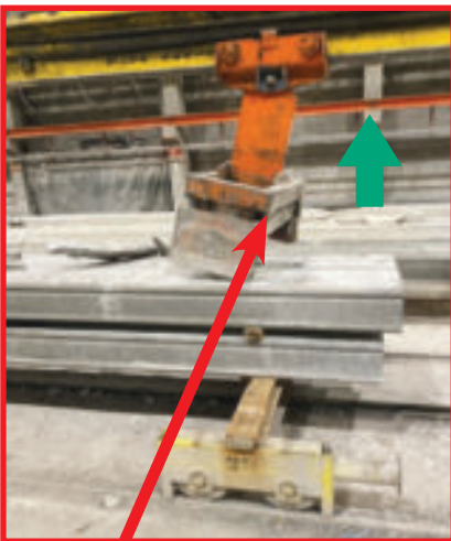
Toen de plaat op zijn plaats was neergelaten - liet de bediener de grijpers / klemmen los en tilde de klemmen hoger op om ze van de volgende taak weg te brengen.
