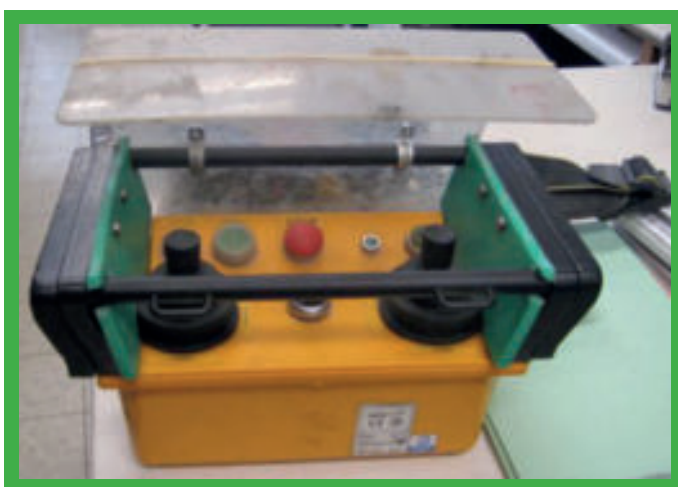
Dodemansjoystick. Indrukken om de joystick te activeren.
