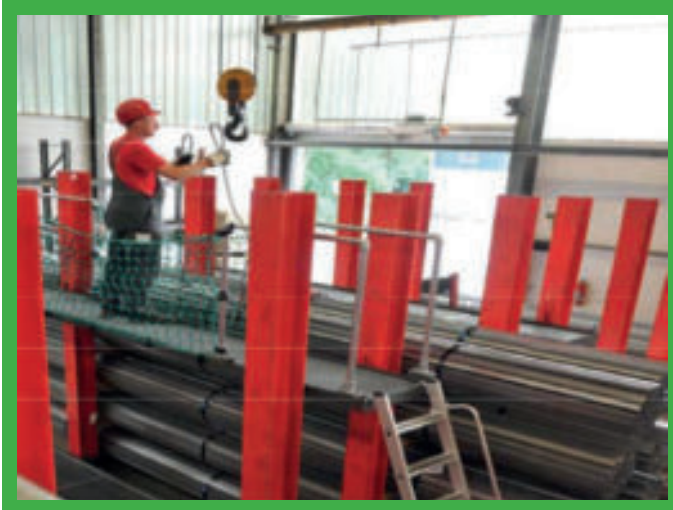
Veilige toegang voor het vastmaken van hijshaken.
