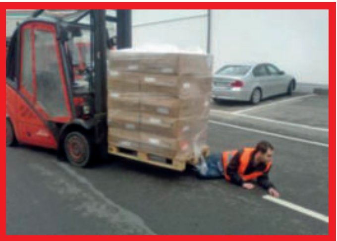
Reconstructie van een ernstig ongeval – mei 2015: Werknemer werd aangereden door een vooruitrijdende vorkheftruck. Het zicht van de chauffeur werd belemmerd door de lading.
