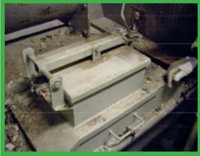
Inspectieluik (met beveiligd rooster) op een schroeftransportband.
