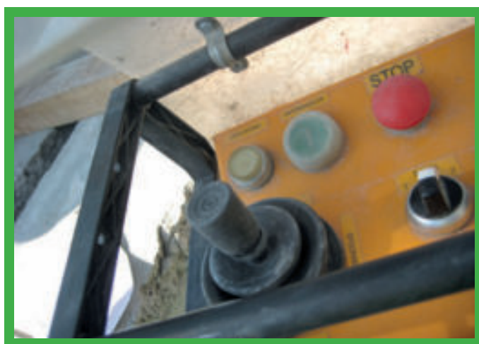
Dodemansjoystick. Indrukken om de joystick te activeren.
