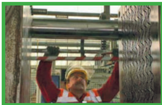
Mechanische isolatie: een schuifdeur beveiligen (mechanisch + hangslot).
