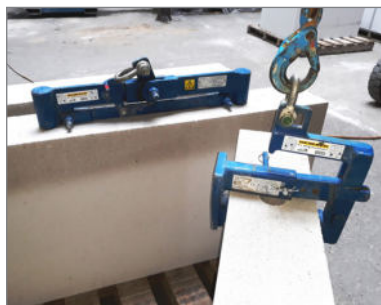
Links: elementenklem Rechts: gebruik passtukkenklem
