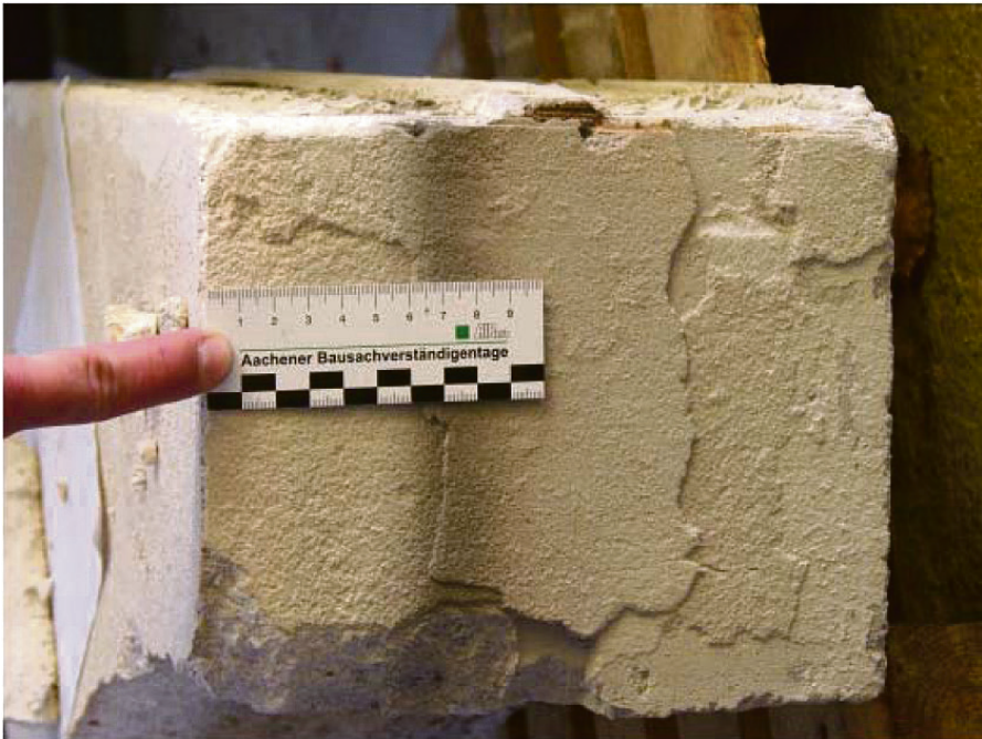
▲ Afbeelding 1: De zichtbare kleurverandering door chemische omzetting van CSH-fasen na een vuurbelasting.
