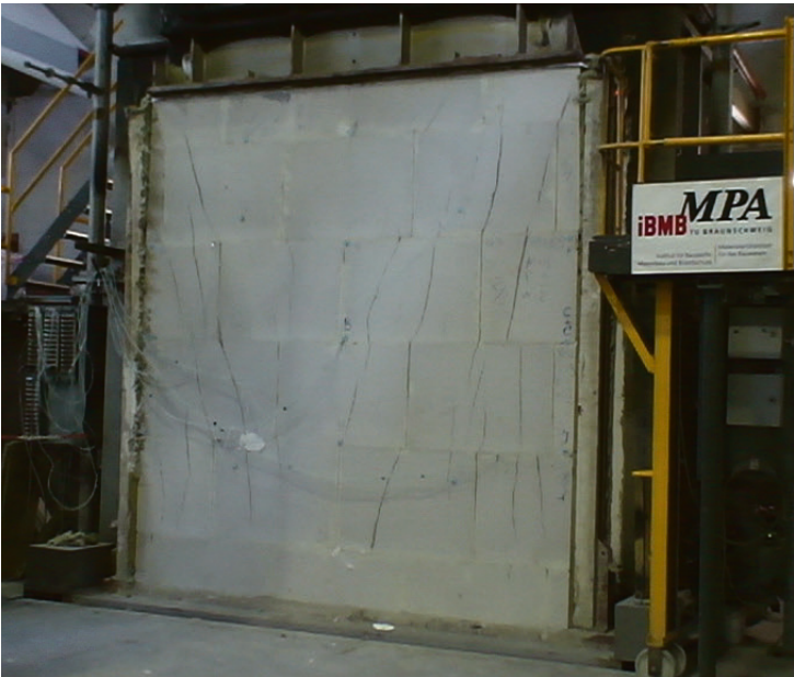
◀ Afbeelding 2: Test brandwerendheid.
